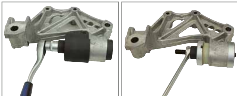
Ausbau und Einbau des Silentlagers
