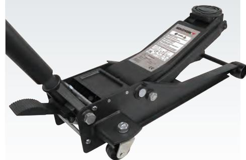
Robuster Rangierheber für den ambitionierten Einsatz. Die niedrige Aufnahmehöhe von 75 mm bietet ein breites Anwendungsfeld auch bei tiefergelegten Fahrzeugen oder Fahrzeugen mit Seitenschwellern. Der integrierte Fußschnellhub erleichtert den Ansatz am Fahrzeug.
