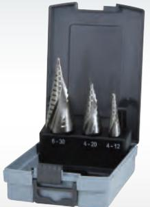
Aus Hochleistungsschnellarbeitsstahl mit tiefgeschliffener, spiralförmiger Spannut für einen ruhigen Lauf und einer extrem langen Standzeit. Kein Verrutschen durch den speziellen Kreuzanschliff an der Spitze. In robuster Kunststoffkassette.
