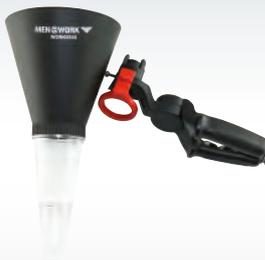
Durch die selbstklemmende Funktion kann der Trichter an nahezu jeder Öffnung festgeklemmt werden. Damit ist der Trichter fixiert und beide Hände bleiben frei zum Befüllen. Die Halterung ist in der Höhe verstellbar, wodurch auch handelsübliche Trichter verwendet werden können.
