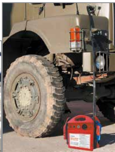
Startvorgang an einem Panzer mit Nato-Doppelstecker
