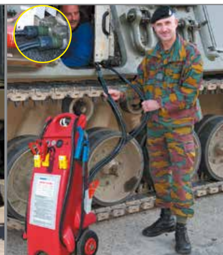
Startvorgang an einem Panzer mit Nato-Doppelstecker
